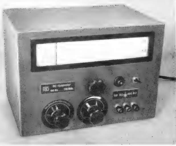
Bild 1. Außenansicht des RC-Generators.
